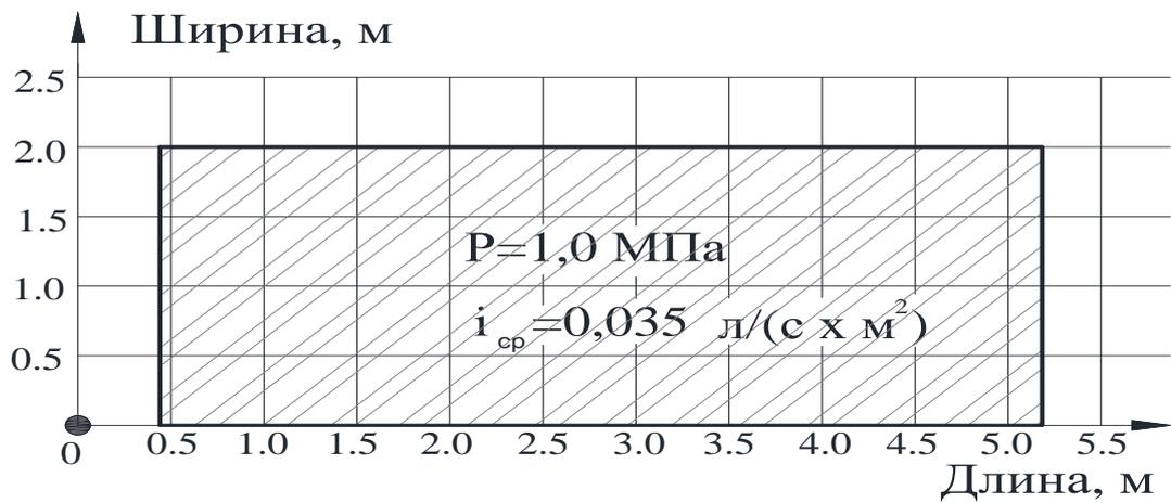
График зависимости интенсивности от давления для водяных распылителей для высоты 2,5 м и площади 20 м<sup>2</sup>
